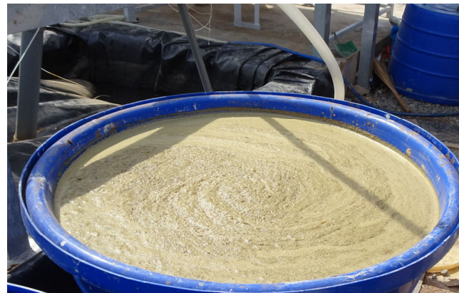
汚泥とレモングラス粉末、 水酸化カルシウム水溶液との 混合後の状態
