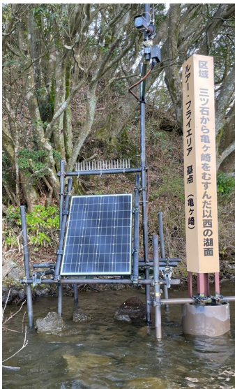
湖岸の監視カメラ (ソーラーパネルと バッテリーで稼働)
