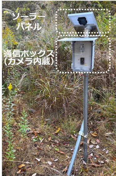
これらのセンサーやカメラは LoRaWAN®に対応することで通信コストを大幅に抑え、安価なランニングコストでの運用を可能にします。また、多種多様なセンサーで同じ通信インフラ(基地局)を共有することにより、水利施設の管理以外にも、施設園芸、見守り、防災システムなど多用途に展開することができます。IIJ は、自治体や土地改良区が地域で通信インフラを整備する際、適切なエリア設計やシミュレーションなど、導入に向けた具体的な課題解決や無線基地局の整備設計についても支援いたします。
