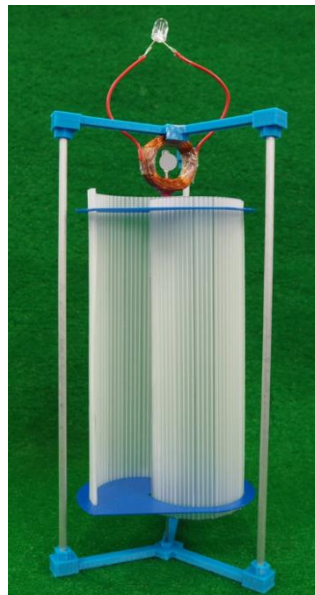
発電機(写真左上)と IoT センサー(写真左下)、小型サボニウス風車(写真右)
