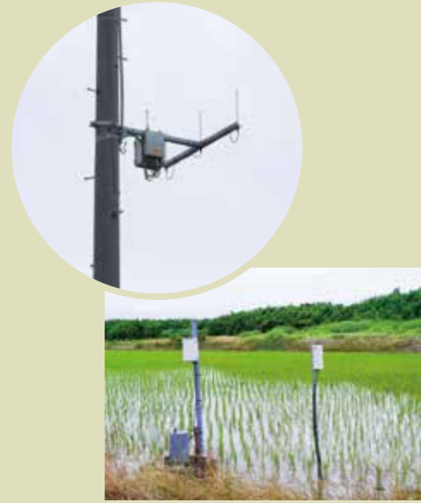
上：LoRaWAN 基地局 下：自動給水弁(左)と水田センサー(右)
