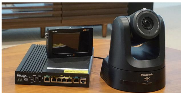
写真-12: PTZリモートカメラ(右)とL3VPNを構築させたSEIL(左)
