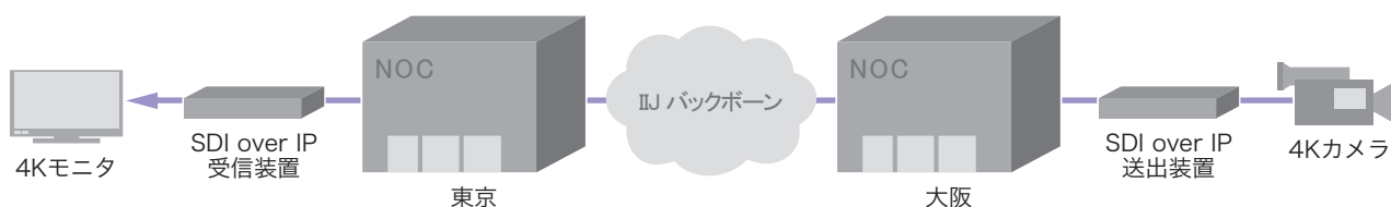
図-2 IIJバックボーンを利用したSDI over IP実験
